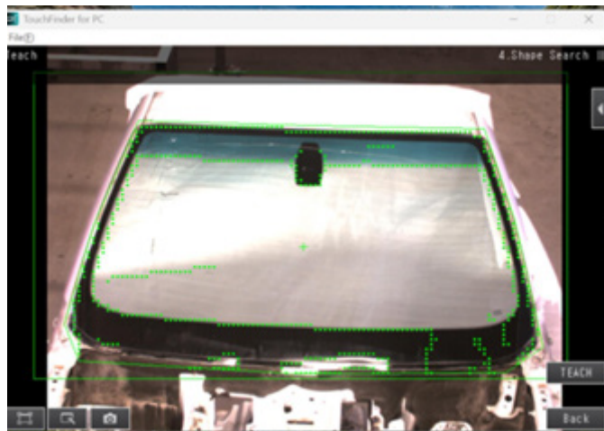
Kuva 12. Työstöradan määrittely konenäön avulla tuulilasin irrottamiseksi
