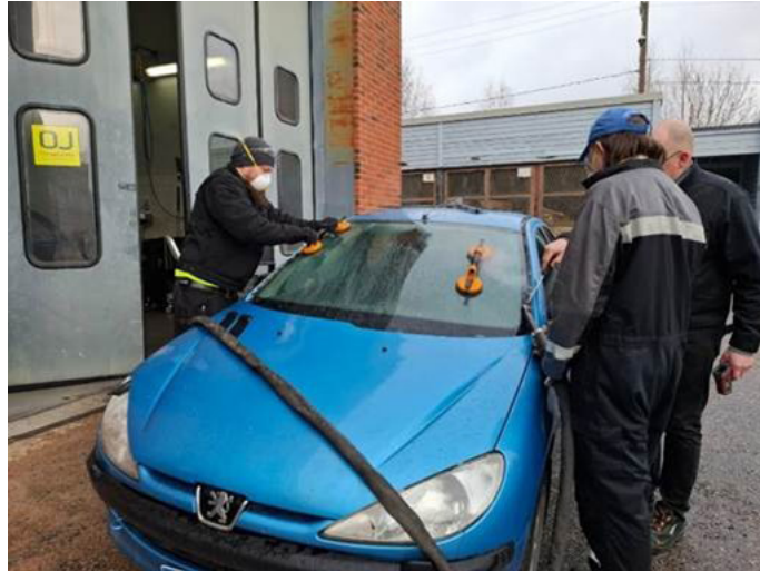
Kuva 9. Tuulilasin irrotus induktiokuumentimella.
