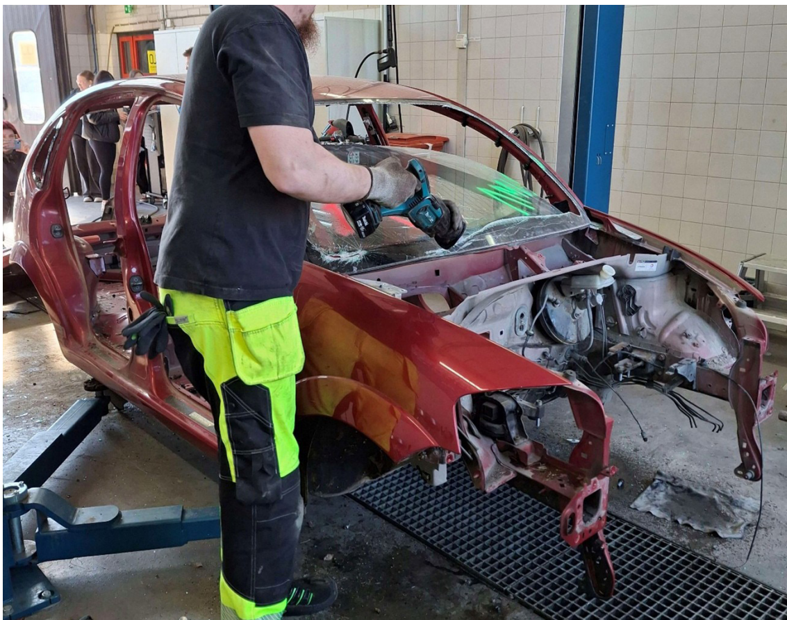
Kuva 3. Tuulilasin leikkaaminen puukkosahalla.
