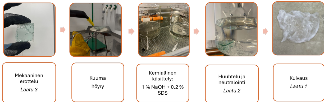
Kuva 15. PVB-kalvon ja lasin erotteluprosessi tavoiteltuine PVB:n laatuluokkineen (Kössi, ym. 2025).
