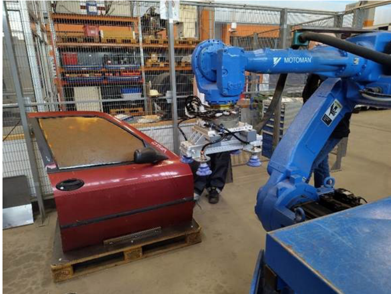
Kuva 10. Testi karkaistun lasin käsittely -robotilla, missä neljän imukupin tarttuja.
