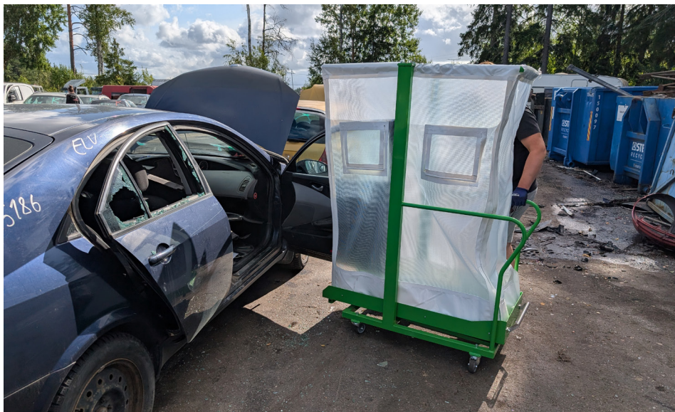
Kuva 6. Lasin keräämisessä käytetyn kärryn asettelu oven alle.
