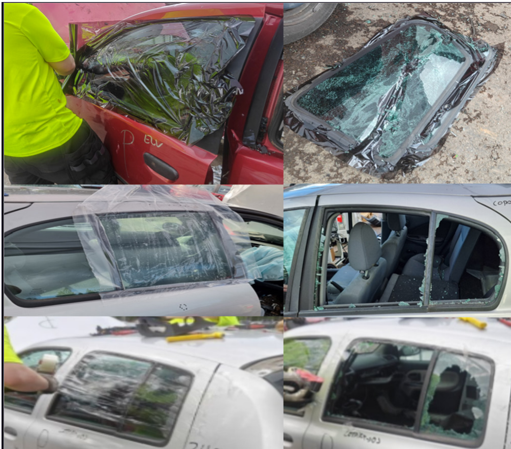
Kuva 2. Karkaistun lasin poistoa kalvottamalla.
