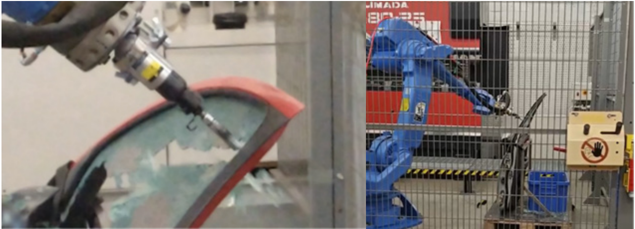
Kuva 14. Testi sivulasien rikkomisesta robotisoidusti.
